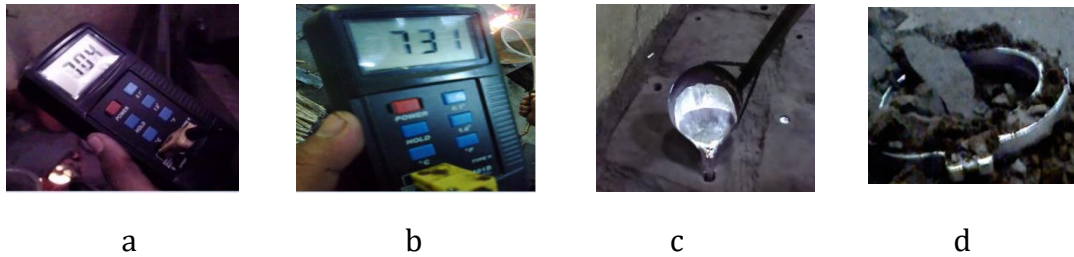
Gambar 2. a) suhu berhenti pengadukan; b) suhu tuang; c) penuangan; d) pembongkaran cetakan
