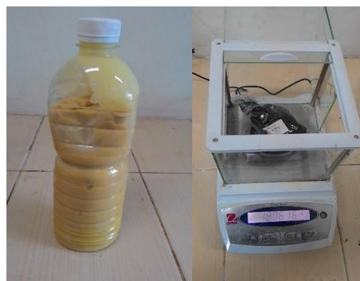
Gambar 3. Zat padat hasil pirolisis limbah plastik HDPE (a) Sejenis nafta dan (b) Karbon
