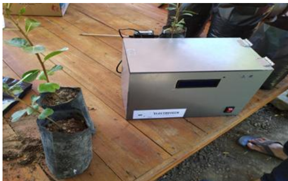
Gambar 7. Alat pendeteksi pH tanah Biotro
